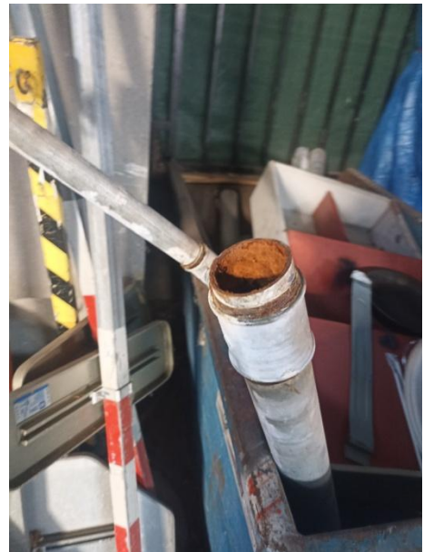
Pohled na vnitřní povrch z potrubí, které bylo vyměněno při poslední havárii (cca 11/2024)
