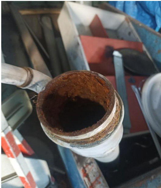
Pohled na vnitřní povrch z potrubí, které bylo vyměněno při poslední havárii (cca 11/2024)
